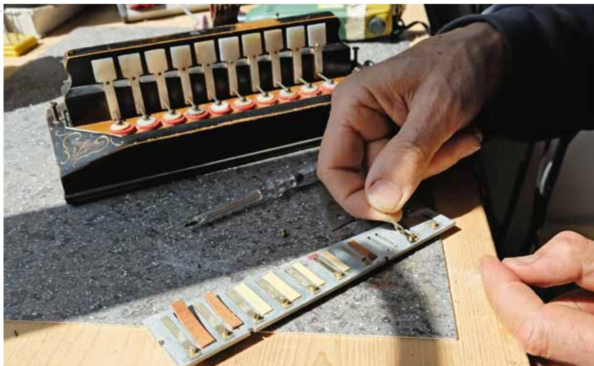
Das Herz eines Akkordeons ist die Stimmzunge. Ein Luftstrom bringt die durchschlagende Zunge aus Metall zum Schwingen und erzeugt damit den Ton. Je nach Grösse dieser Stimmzungen werden verschieden hohe und tiefe Töne erzielt. Die Restauration im Innern des Instruments erfordert äusserst präzises Arbeiten.
